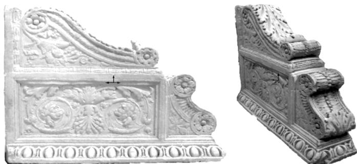
Рис. 2. Облако точек кронштейна, полученное лазерным сканером
