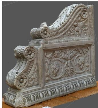
Рис. 5. Облако точек кронштейна, полученное методом фотограмметрии
