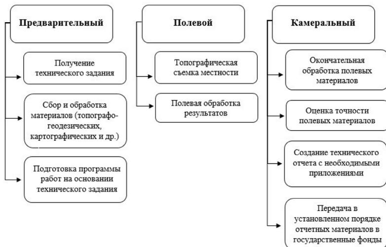
Рис. 1. Этапы формирования топографического плана
